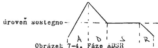
Commodore 128 může měnit všechny parametry ADSR, maximálně 16 různých hodnot. Umožnuje to dosáhnout velké flexibility generátoru ENVELOPE a vlastnosti sily generovaného zvuku.
