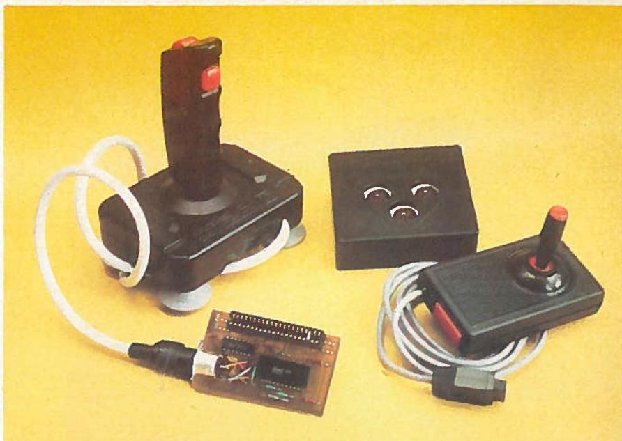
Jak je patrné z úvodu, dnes vám chceme představit tři užitečné výrobky naší spotřební elektroniky — dva typy křížových ovladačů a jeden interface (interfejs) k jednomu z nich. Jsou určeny majitelům mikropočítačů, kteří chtějí hrát hry bez nadměrného opotřebení klávesnice.
