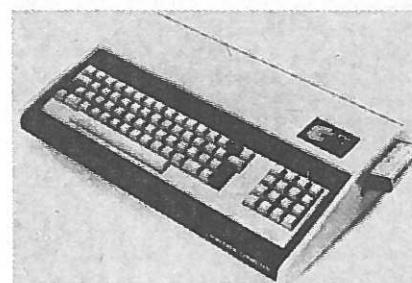
Obr. 40. Mikropočítač Sorcerer firmy Exidy Inc. Kazeta s pamětí ROM se zasouvá vpravo do skřínky mikropočítače
