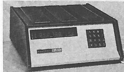
Obr. 30. Mikropočítač Heathkit H 8
