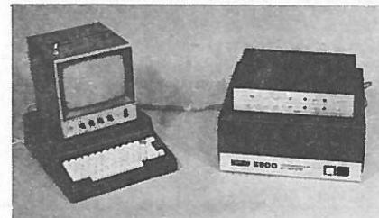
Obr. 23. Mikropočítáč SWPTC 6800 se stykovým zařízením pro nf kazetu, s klávesnicí a s obrazovkovým displejem
